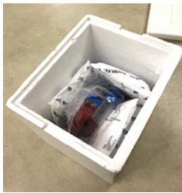
Colocar la bolsa dentro de una hielera o sobre metálico térmico con gel refrigerante para mantener a una temperatura de 9° centígrados.
